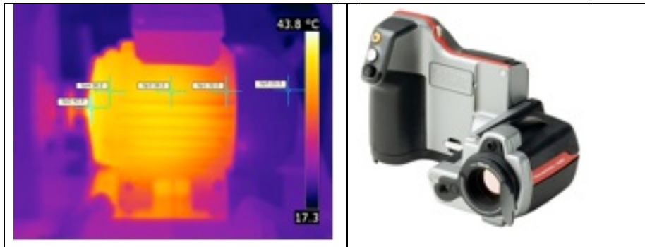
Thermobild des oben gemessenen Elektromotors auf dem Prüfstand. Man kann klar erkennen, dass am vorderen Lager die Temperatur am höchsten ist.
